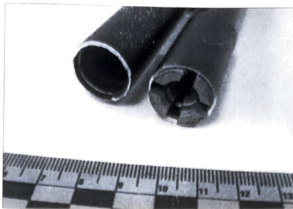
Зображення 6. Вузол розлому середньої секції (діаметром – 20,5 мм).
